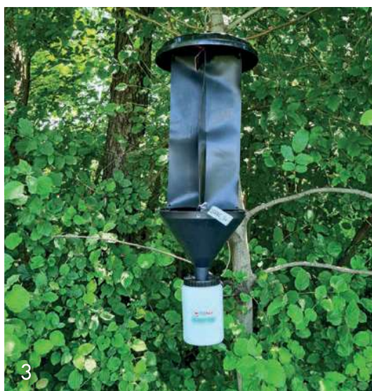
3. Trappola "cross-vane" utilizzata per coleotteri del genere Anoplophora .
