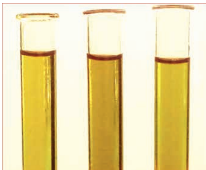
Figura 4: Campioni di olio di canapa ottenuti, mediante spremitura meccanica, da lotti di seme di qualità e conservazione del seme idonea (sinistra) e non idonea (destra). Per termine "idoneo" vedere nel testo.
