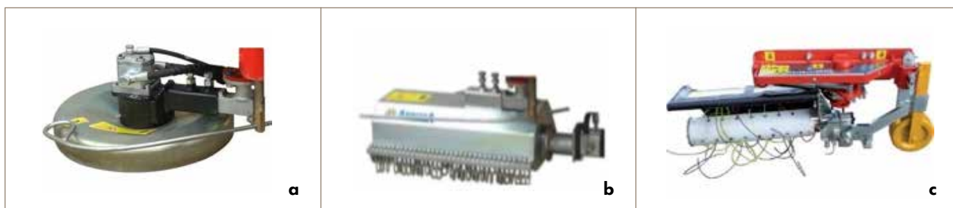
Figura 2: Alcune tipologie di testate per trinciaerba: a) a lama, b) a mazze, c) a filo (foto archivio UNIUD).
