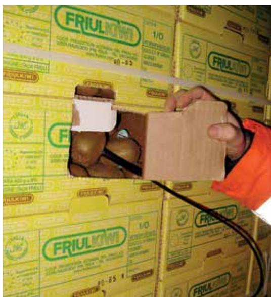
Figura 3: Sonda termica posizionata dentro i frutti in una spedizione di kiwi.
