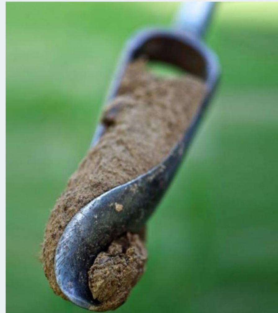
Laddove un'interpretazione a video è risultata impossibile, si è proceduto effettuando **controlli con sopralluoghi in loco** secondo le metodologie pedologiche vigenti, ossia con campionamento con trivella manuale fino al raggiungimento del substrato roccioso.
