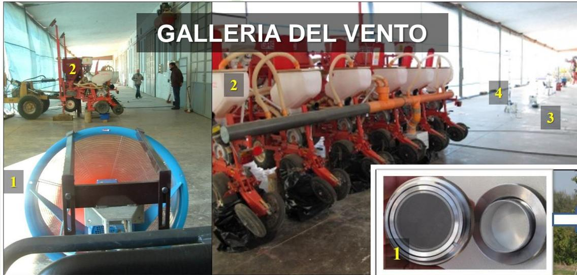
Simulazione semina con macchina a punto fisso in **galleria del vento** per studio della **DERIVA**
