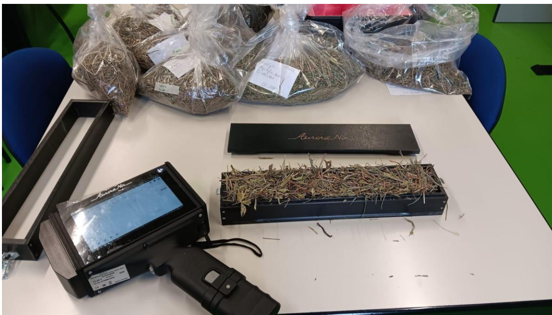
Figura 5: preparazione dei campioni di fieno per le analisi con spettrometro NIR portatile. Foto: V. Cecchini.
